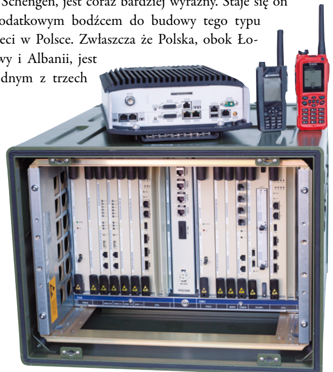
Centrala DXT3p, stacja bazowa TETRA TB3p, radiotelefony TH1n i THR9ex
