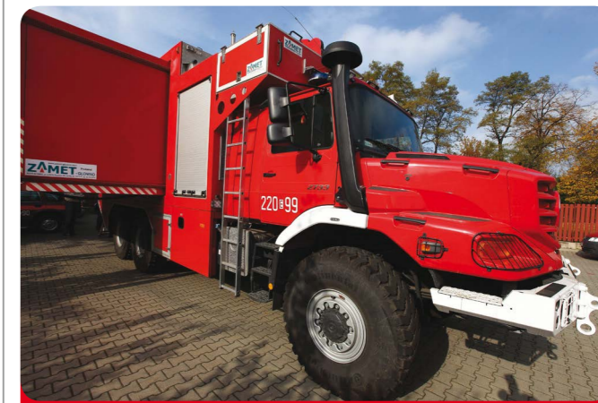
Nadwozie pojazdu umieszczone jest na wysokości 1,2 metra. Dzięki temu samochód może bezpiecznie poruszać się nawet po terenach częściowo zalanych.
